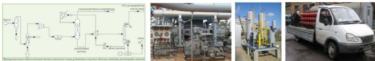
Рис. 7.2.2 – Технологічна схема отримання біометану
