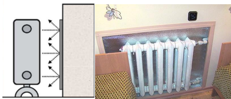
Рисунок 2.7 — Влаштування віддзеркалювального екрану на радіаторній ділянці стіни
