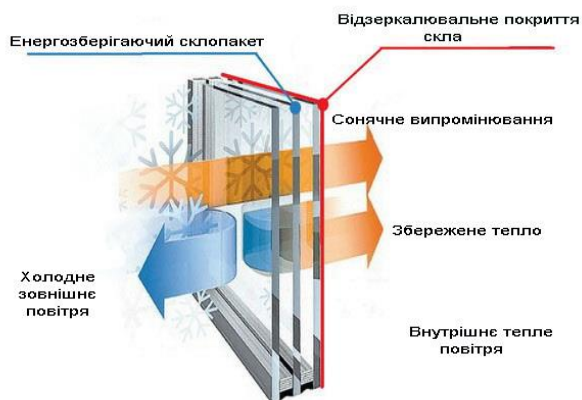
Рисунок 2.15 — Схема теплових потоків для енергозберігаючого заповнення
